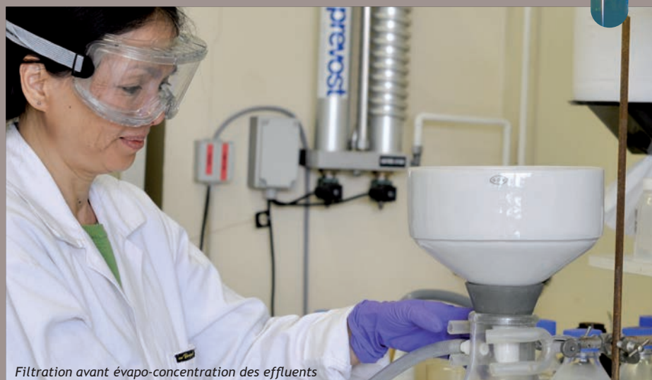
Filtration avant évapo-concentration des effluents
