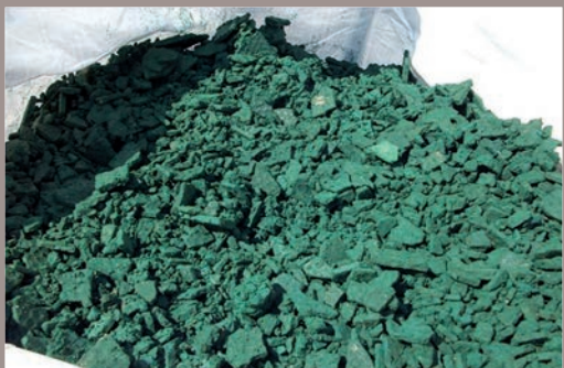
Gâteaux contenant du cobalt après précipitation sélective de déchets liquides
