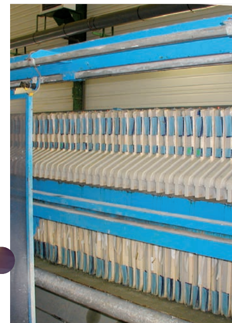
Filtre-pressé utilisé pour la précipitation sélective
