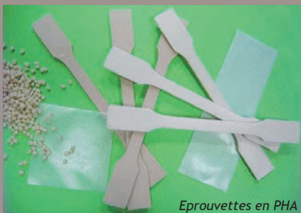
Eprouvettes en PHA
