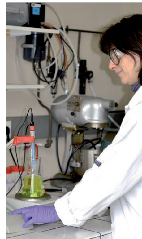
Mesure du pH sur le concentrat
