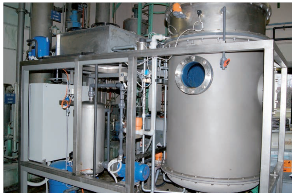
Evapo-concentrateur pour bains chromiques
